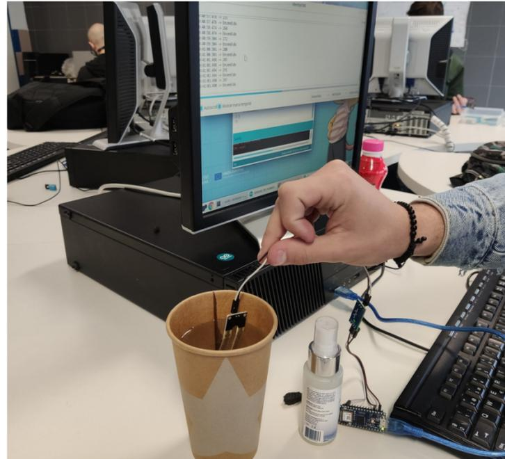
Algunos sensores analógicos debemos calibrarlo. La actividad se realiza con un sensor de humedad y un vaso de agua para saturarlo al 100% y correlacionar el valor leído.
